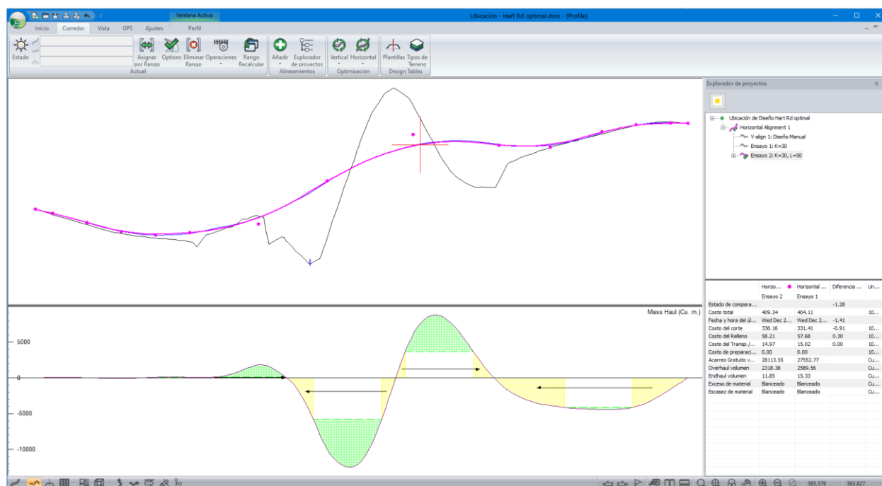
Figura 5-3: Diferencia Entre Alineamientos Generados Curva contra Curva y Curvas de 50m
