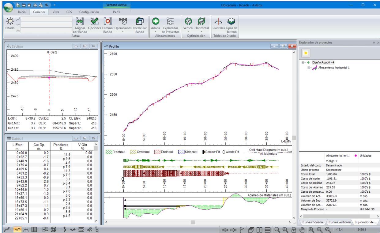
Figura 16-2 – Diagrama de Masas Balanceado Después de Agregar un Foso de Volumen Variable
