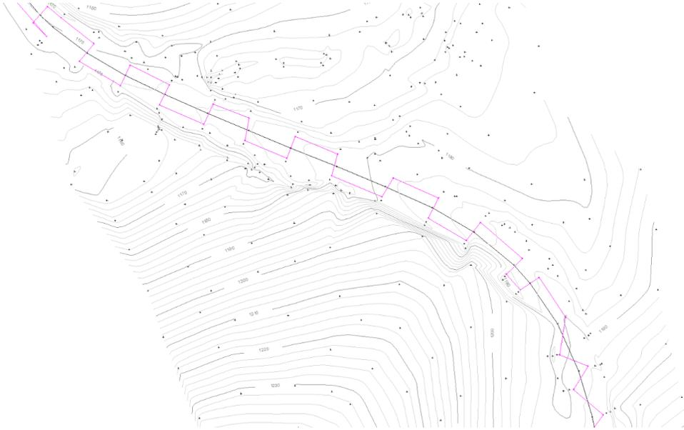
Figura 8-5: Bordes de Pavimento Conectados Mediante la Función Unión
